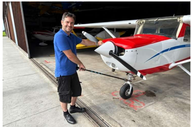
Tow Bar (Stange) montiert, Hand an der Propellerwurzel
