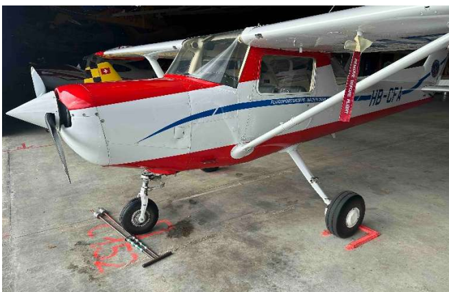
Cessna korrekt positioniert, linkes Hauptfahrwerk in der vorgesehenen Mulde, Stange als Radschuh
